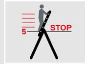
Mehrzweckleitern in der Gebrauchsstellung „Stehleiter mit Steckteil“ dürfen nur bis zur fünftobersten Sprosse bestiegen werden.
