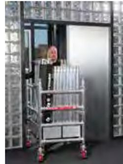
Aus den Gerüstbauteilen kann schnell ein Wagen zusammengestellt werden. Passt durch jede gängige Türöffnung und in viele Firmenwagen.
