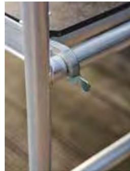
Die Plattform ist mit einer Abhebesicherung versehen, die einen einfachen Auf- und Abbau ermöglicht.
