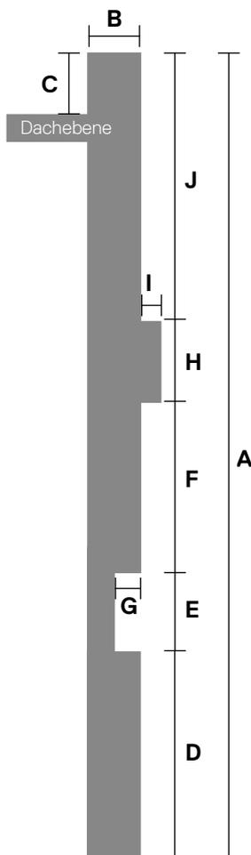
**A** Senkrechte Steighöhe (Boden bis Oberkante der Aufstiegshöhe)
